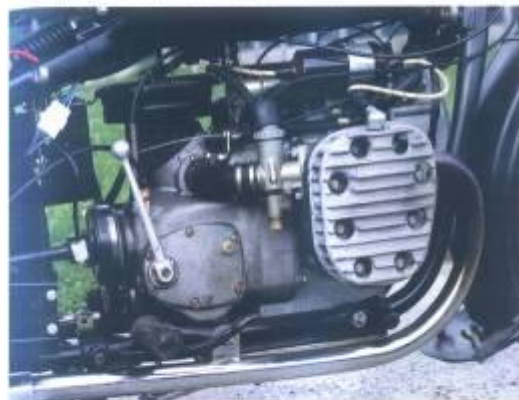
Le fouillis de câbles et de fils électrique ne donne pas un aspect très fini. Le démarreur est au-dessus du bloc et le carter AV abrite l'alternateur 12 V. Le levier de vitesses à main facilite la recherche du point mort.
